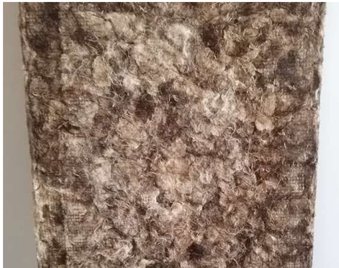
Figura 3 - Pannello isolante autoportante in lana-canapa
