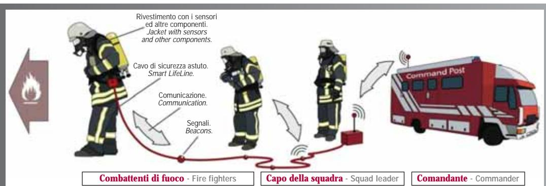
**Figura 1. Il sistema Profitex.** - Figure 1. The Profitex system.
