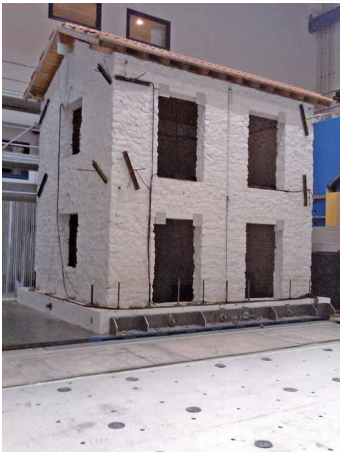
Figura 7. Edificio in pietra testato presso l'EUCENTRE (Pavia, Italia) Figure 7. Two storey stone masonry building tested at the EUCENTRE (Pavia, Italy)
