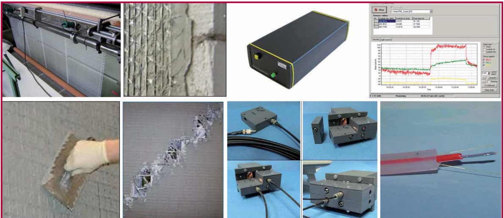
Figura 2. Alcuni risultati del progetto POLYTECT: applicazione e test della tappezzeria antisismica in composito (Karlsruhe Institute of Technology, KIT, Germania) con un rinforzo tessile sensorizzato (STFI, Germania, e SELCOM, Italia), e sensori a fibra ottica e centraline di acquisizione (Smartec, Svizzera, e Interlab, Spagna) Figure 2. Several Polytect Products: the application and testing of the seismic wallpaper composite (Karlsruhe Institute of Technology, KIT, Germany), with a sensor embedded textile pattern (STFI, Germany, and SELCOM, Italy), and novel fiber optic sensors and equipment (Smartec, Switzerland, and Interlab, Spain)
